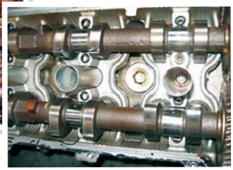
オイル交換をサボったエンジン 内部と正常なエンジン内部
