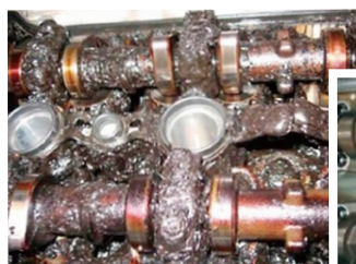
オイル交換をサボったエンジン 内部と正常なエンジン内部
